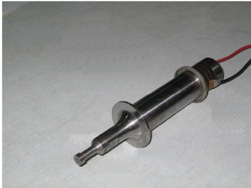
图 4 超声振动振子
