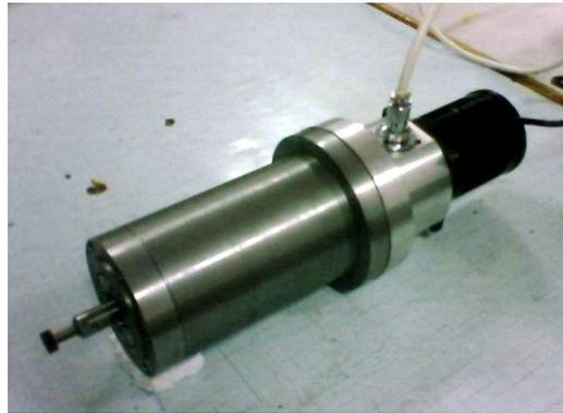
图 5 超声振动内圆磨头
